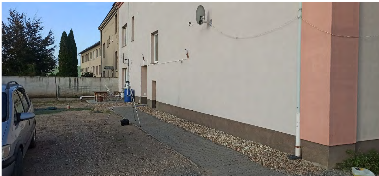
Obr. 19: Měření ekv. hladiny akustického tlaku 2 metry od fasády bytového domu Podivín U dráhy 337/12
