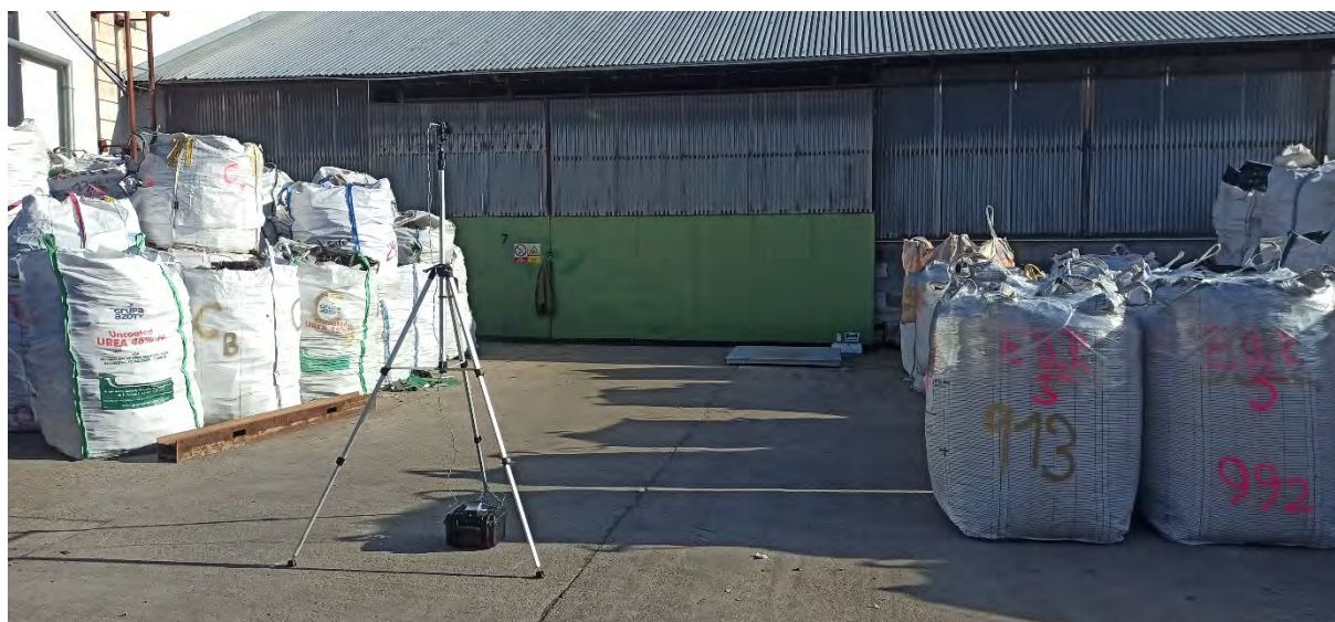
Obr. 13: Měření ekv. hladiny akustického tlaku 10 metrů od hlavních vrat haly s drtičkou elektroodpadu
