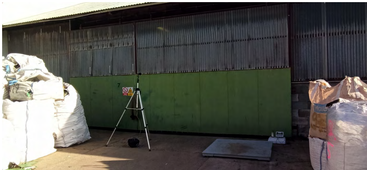
Obr. 10: Měření ekv. hladiny akustického tlaku 1 metr od hlavních vrat haly s drtičkou elektroodpadu
