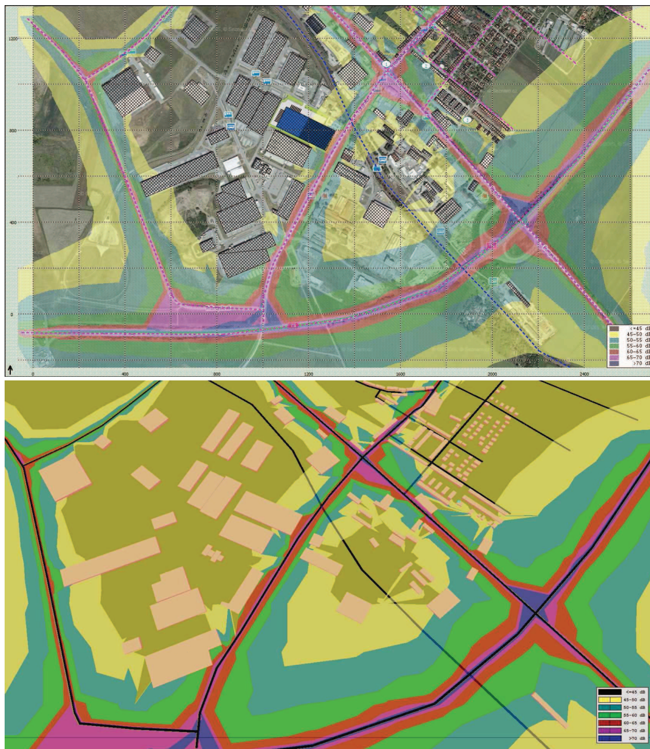
Obr. 5 Grafické znázornění výpočtového modelu - hluk z pozemních komunikací – budoucí stav DEN znázornění pásem izofon - výška izofon 5 m nad terénem
