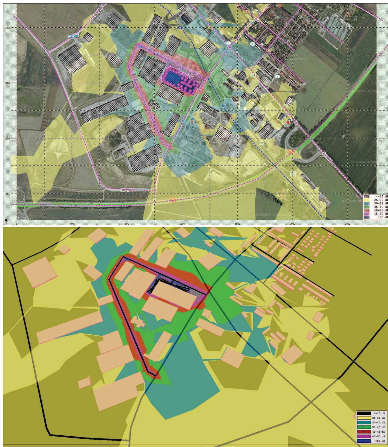
Obr. 9 Grafické znázornění výpočtového modelu – budoucí provoz záměru - NOC - znázornění pásem izofon-výška izofon 5 m nad terénem
