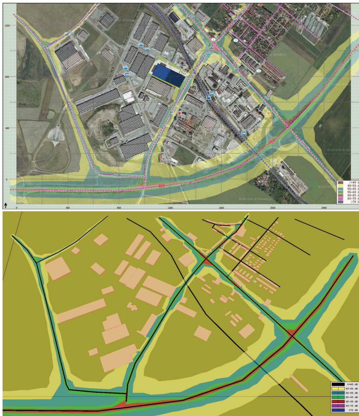
Obr. 7 Grafické znázornění výpočtového modelu - hluk z pozemních komunikací – budoucí stav NOC znázornění pásem izofon - výška izofon 5 m nad terénem
