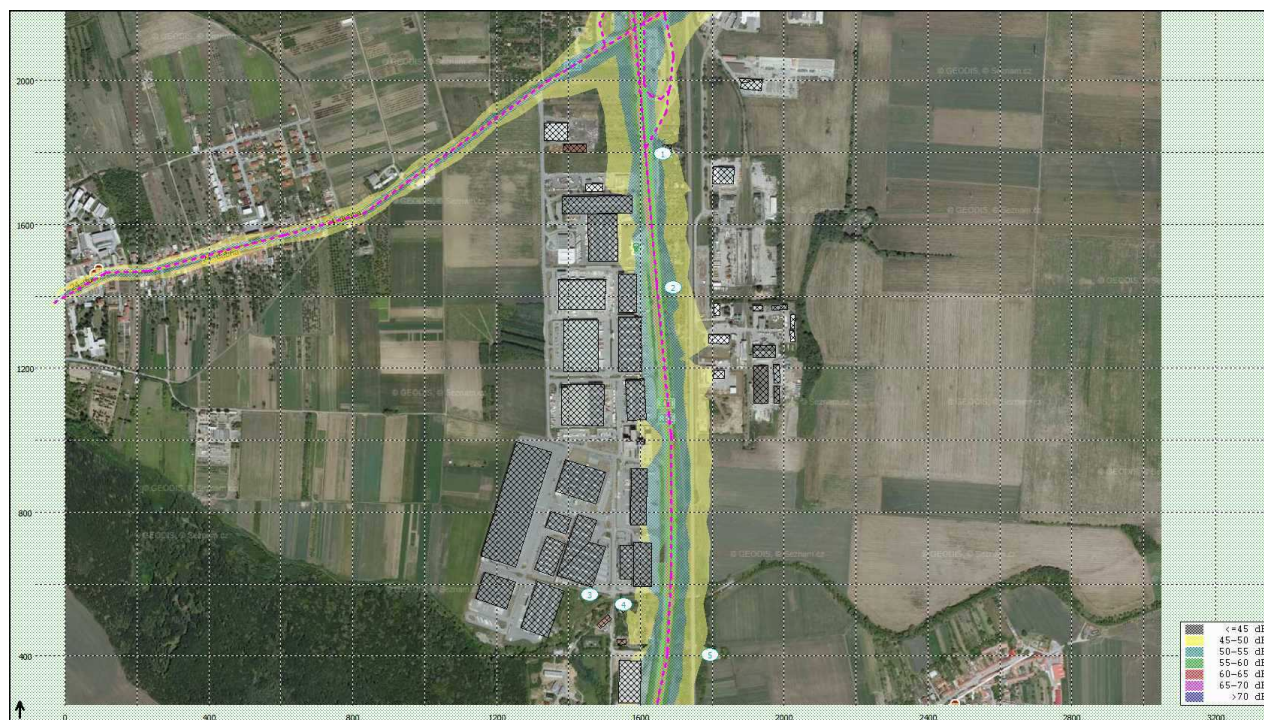
Obr. 11 Znáznění pásem izofon – hluk z dopravy na pozemních komunikacích stávající stav – NOC (Izofony jsou napačteny ve výšce 5m nad terénem).
