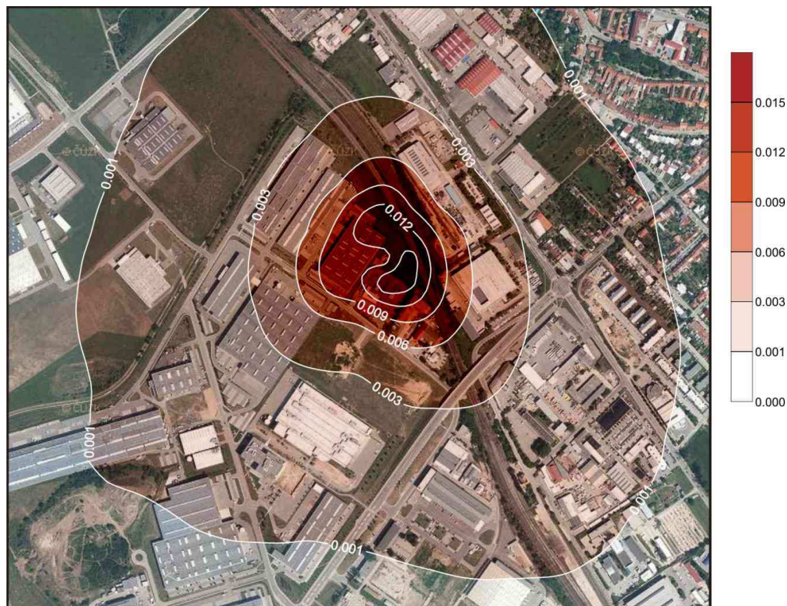
Obr. 4 Změna imisní zátěže tuhými látkami frakce PM_{10} - průměrné roční koncentrace [ \mu\text{g}\cdot\text{m}^{-3} ]
