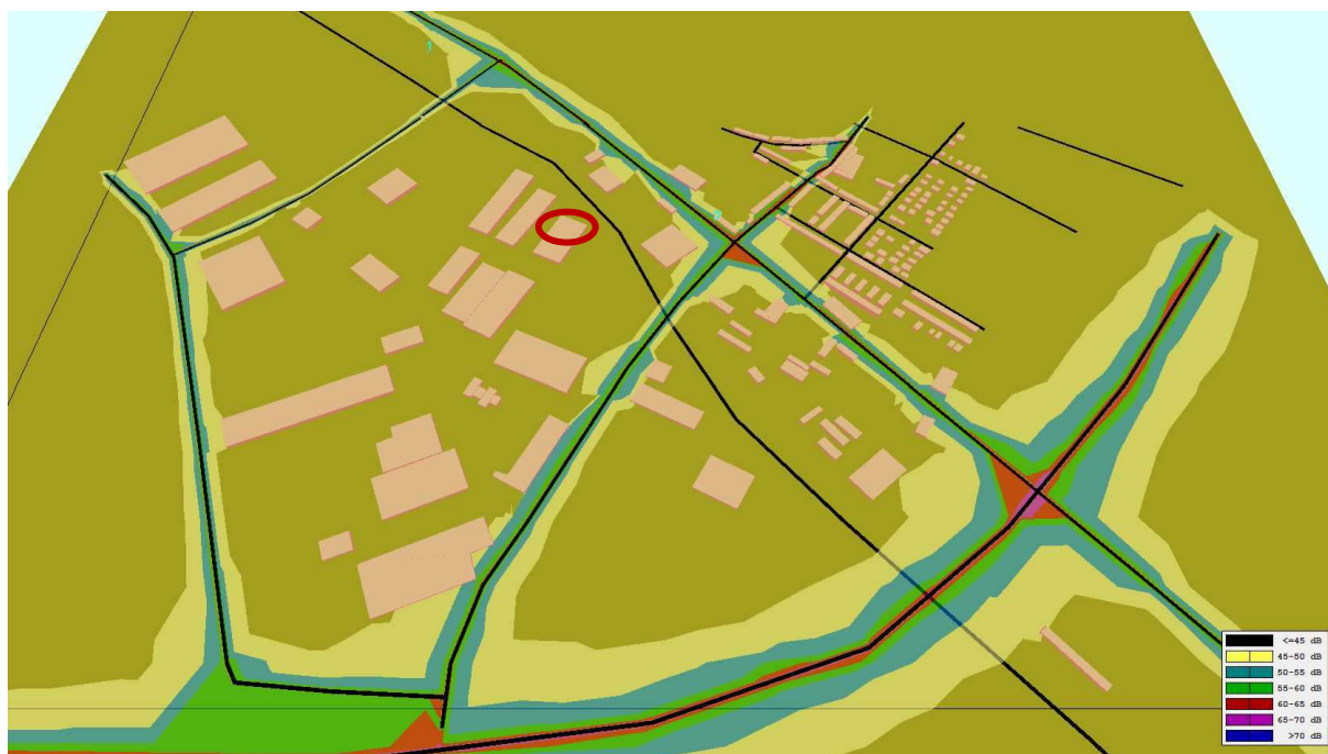
Obr. 5 Grafické znázornění výpočtového modelu - hluk z pozemních komunikací – stávající/budoucí stav NOC znázornění pásem izofon - výška izofon 5m nad terénem
