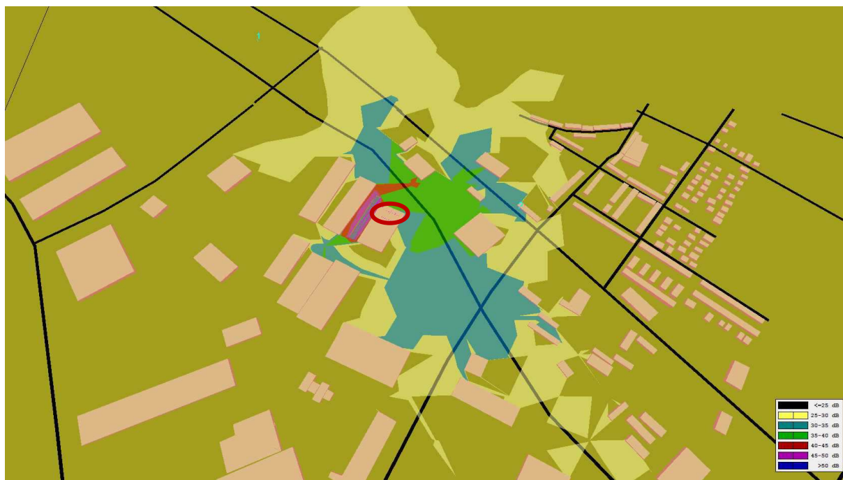
Obr. 6 Grafické znázornění výpočtového modelu – provoz záměru – stávající/budoucí stav DEN znázornění pásem izofon - výška izofon 5m nad terénem
