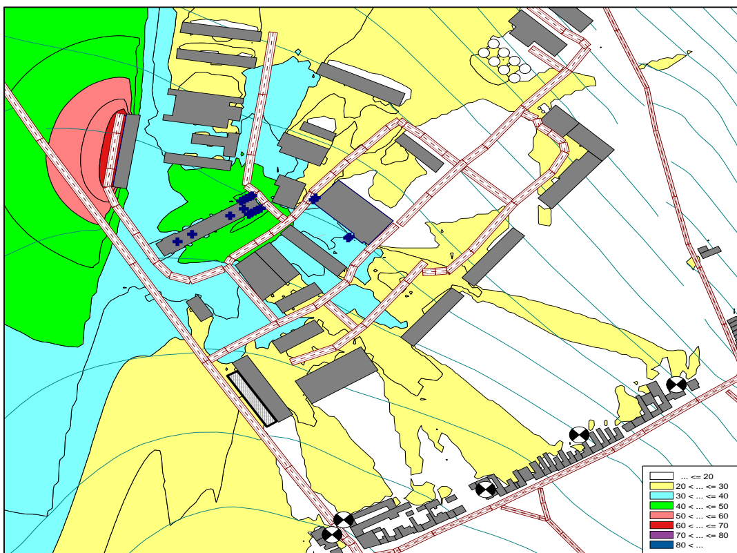
Obrázek 20: Zobrazení izofon ve výšce 2 m - stacionární zdroje hluku výhledový stav, noční doba
