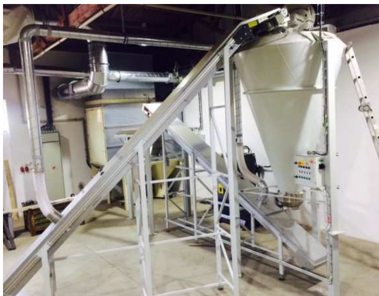
Obr. 3 Pracoviště homogenizace – vlevo vpředu je dopravník dodávající materiál do zásobníku. Po homogenizaci je materiál pomocí dopravníku dopravován do vzorkovacího zařízení. Vlevo vzadu na obrázku je zařízení pro filtraci společné pro nůžky a homogenizátor. Všechny dopravníky jsou homogenizátoru jsou zapouzdřené.
