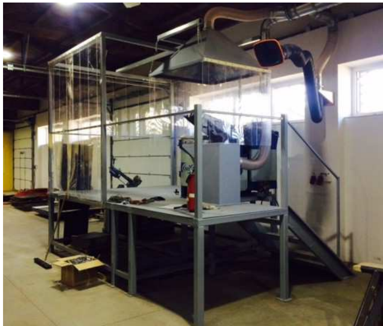
Obr. 1 Pracoviště pro vystříhnutí keramické vložky katalyzátoru – nad nůžkami je umístěno odsávací zařízení, okolo jsou zástěry zabráňující šíření prachu do okolního prostředí
