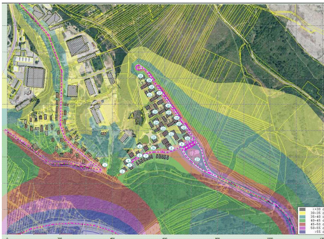
Obr. 7 Grafické znázornění výpočtového modelu - hluk z pozemních komunikací – budoucí stav DENNÍ DOBA - znázornění pásem izofon - výška izofon 5 m nad terénem.
