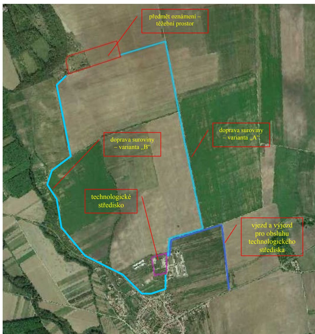
Obr. – dopravní systém těžby suroviny
