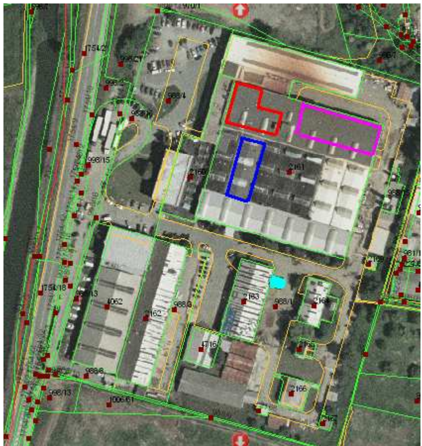
Obr. 3 – Umístění stávající lakovny a odmašťovny IDEAL LINE , nové lakovny IDEAL LINE a kabiny SAIMA GAMMA v rámci výrobního areálu ISAN Blansko
