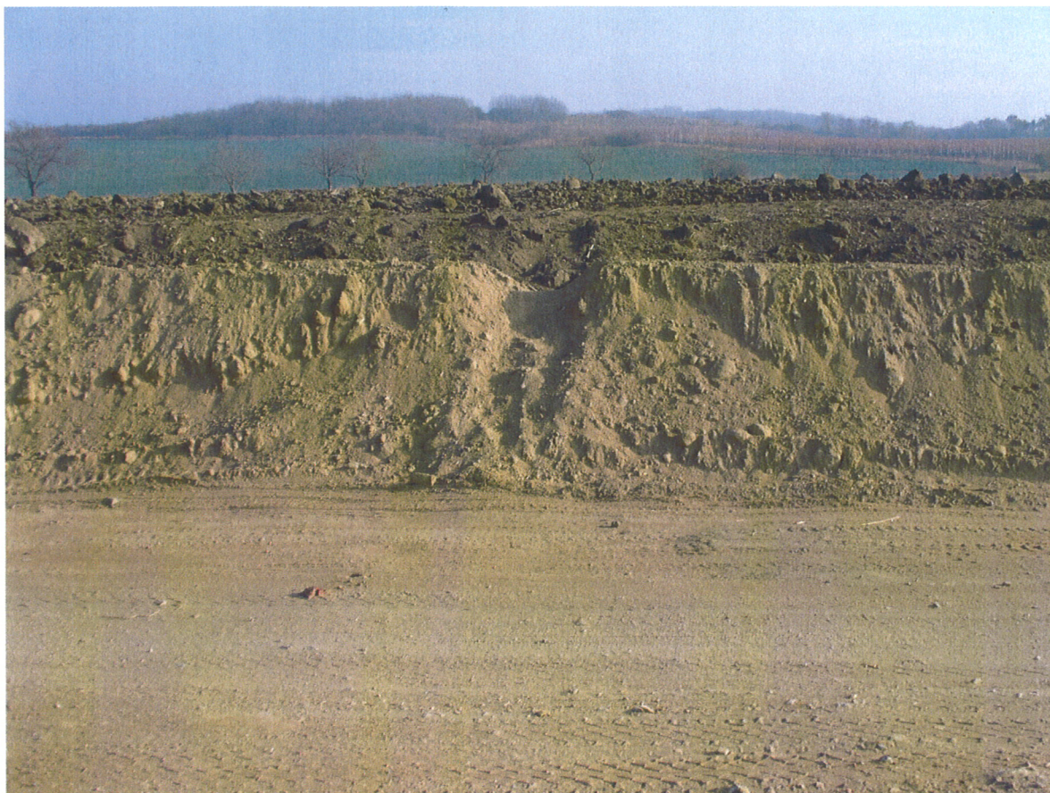
1 Řez rekultivačními horizonty: podorniční 120 cm, ornice 50 cm
