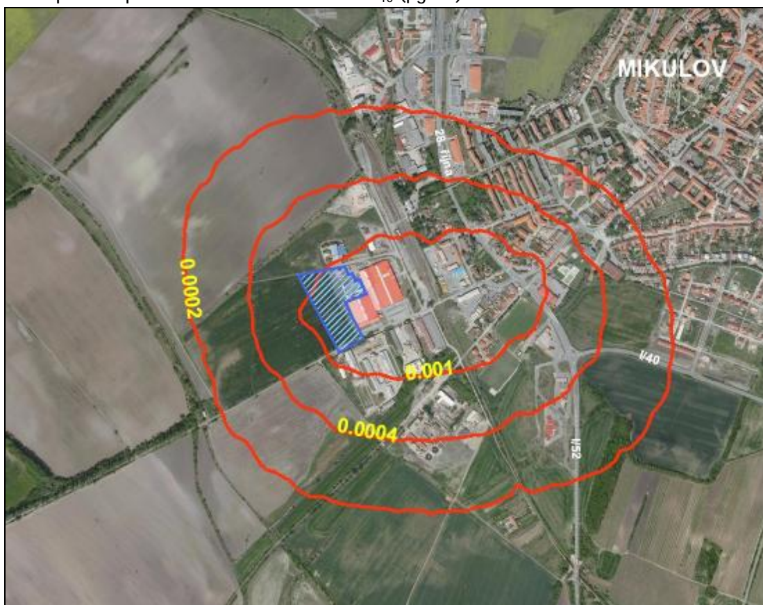
Obr. 21: Přispěvek k průměrné roční koncentraci \text{PM}_{10} ( \mu\text{g}/\text{m}^3 )
