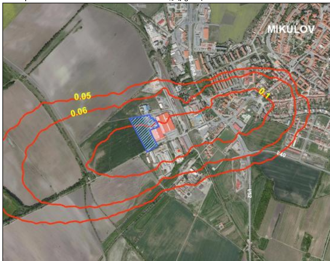
Obr. 22: Příspěvek k maximální denní koncentraci PM 10 (µg/m 3 )
