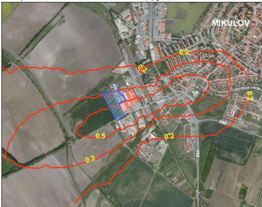
Obr. 19 : Příspěvek k maximální hodinové koncentraci NO 2 (µg/m 3 )
