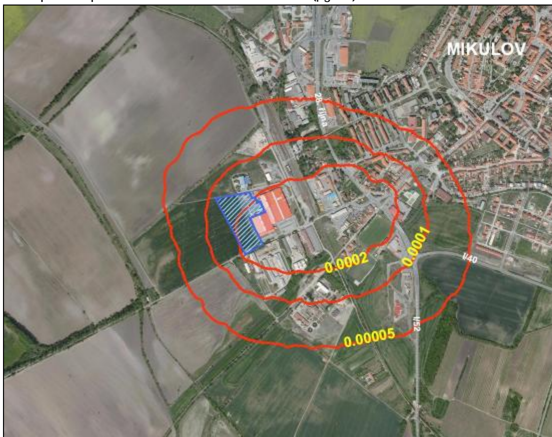
Obr. 21: Přispěvek k průměrné roční koncentraci \text{PM}_{10} ( \mu\text{g}/\text{m}^3 )
