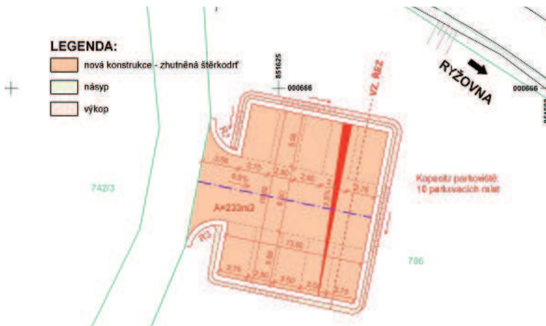
Obr. 5 Výkres navrhované stavby SO 111
