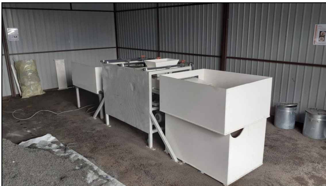
Obr. 3: Recyklační zařízení – vodní oddělovací stůl (foto autor)
