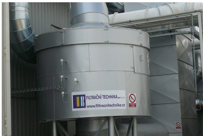
Obrázek 7 – Ukázka reaktoru nízkoteplotní katalytické jednotky, zde ve větší kapacitě
