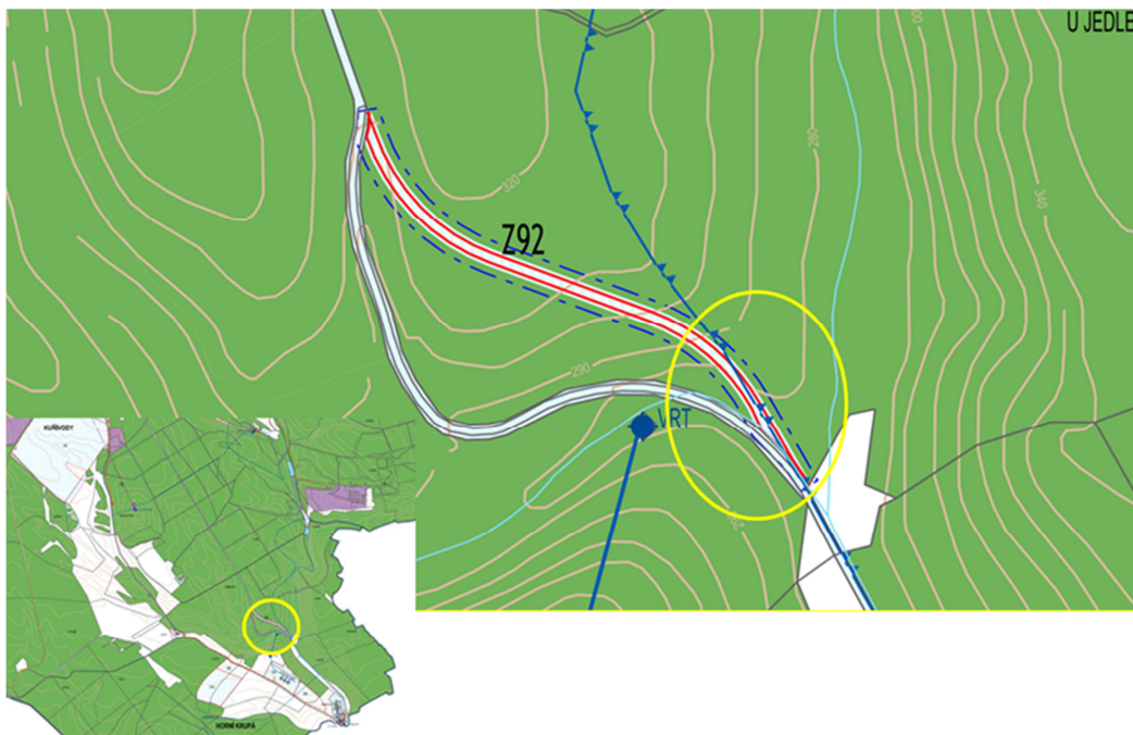
Obrázek 8 Střet trasy záměru a OP vodního zdroje
