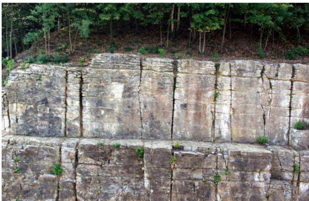
Obrázek 11 Standardní kvádrová blokovitost křídových pískovců v místě záměru
