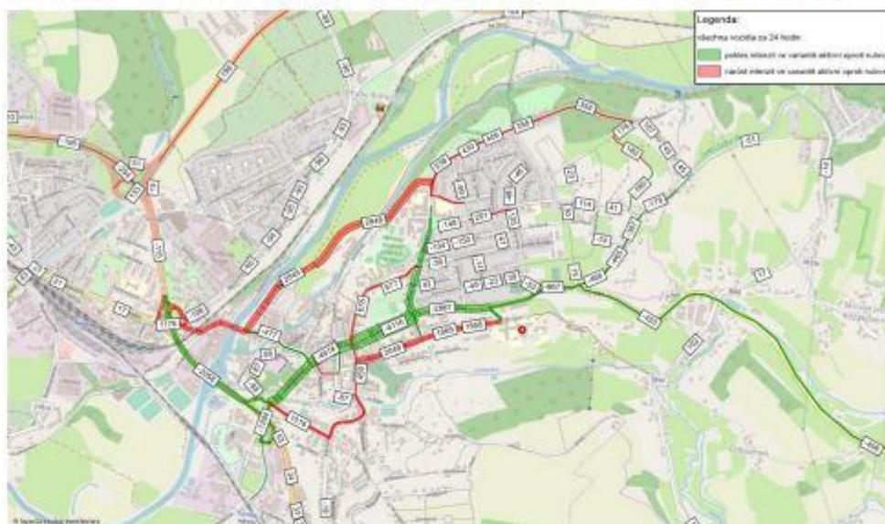
Obrázek 18 – Rozdíl zatížení mezi variantou 4 bez S5 (Metelkovy sady) a variantou 1 (nulovou)
