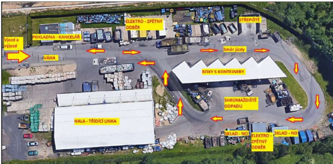
Obrázek 2 Přehledná situace sběrného dvora s vyznačením směru jízdy NA, které přivážejí a odvázejí odpady
