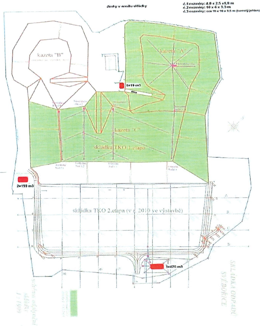
Obrázek 6: Stávající jímky průsakových vod (zvýrazněno červeně) zůstanou k dispozici i pro rozšířenou část skládky
