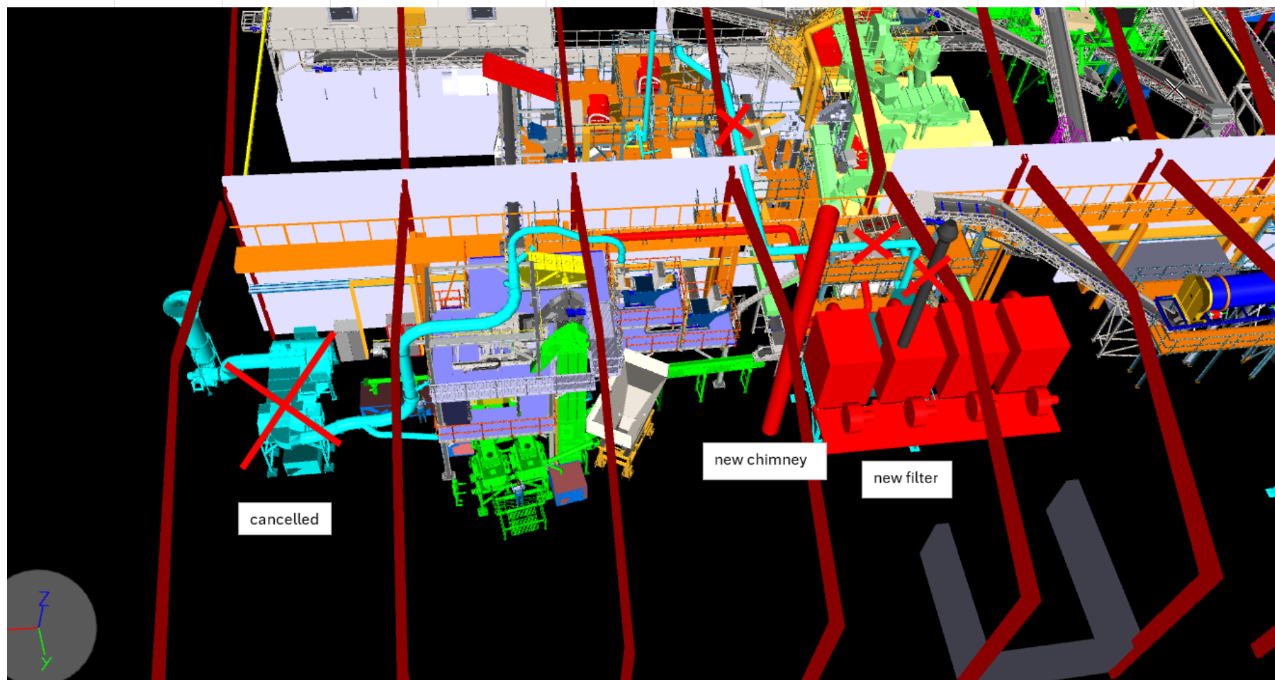
Obrázek č. 18: Nová situace filtrace linek CEEK a POWDER. Mírný posun nového výduchu od původního výduchu linky CEEK.
