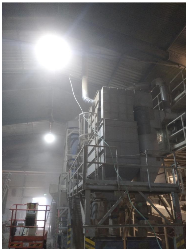
Obrázek č. 37: CEEK filtr drcení a třídění 102
