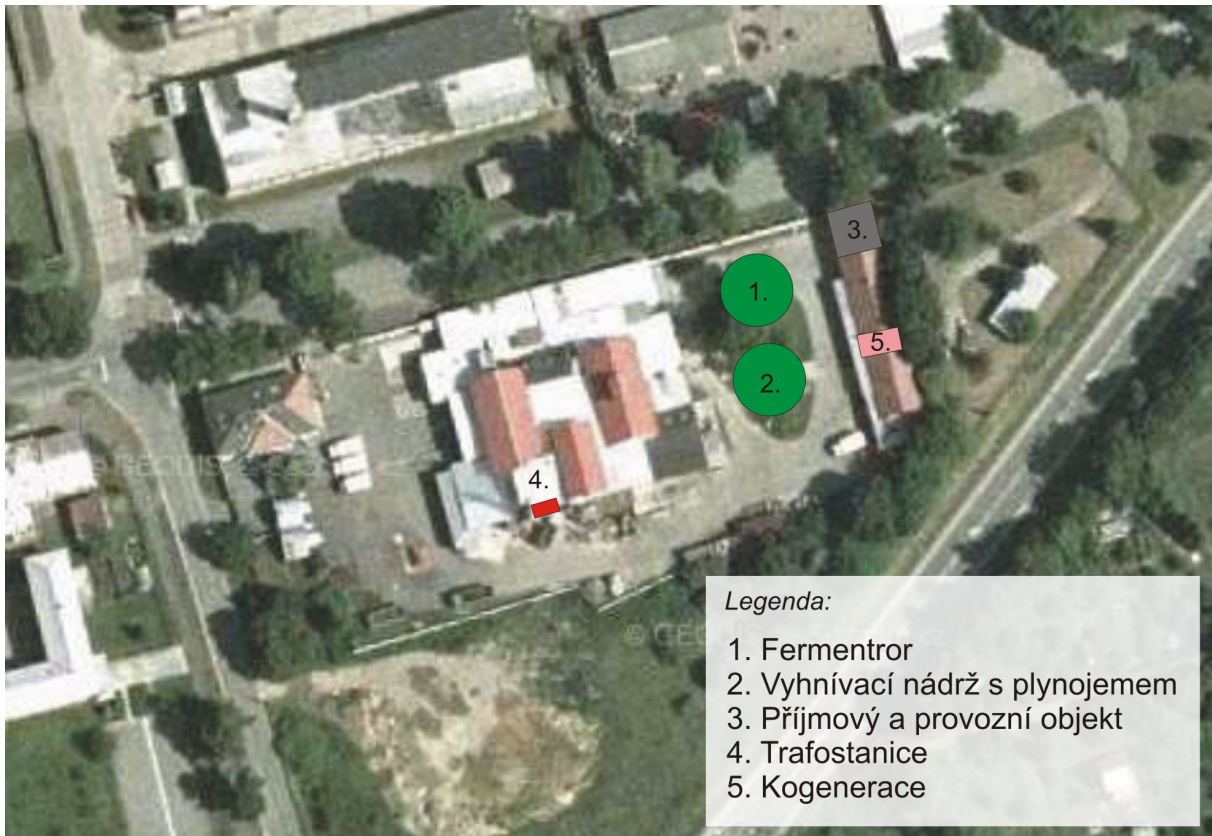
Obrázek 6: Zjednodušená situace rozmístění stávajících a nových objektů
