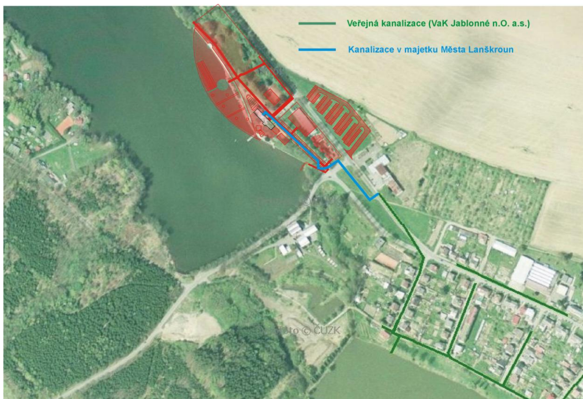
Obr. č. 16: Zákres stavebních objektů do mapy Plánu rozvoje vodovodů a kanalizací Pardubického kraje s vyznačením stávajícího napojení na veřejnou kanalizaci (bez měřítko)
