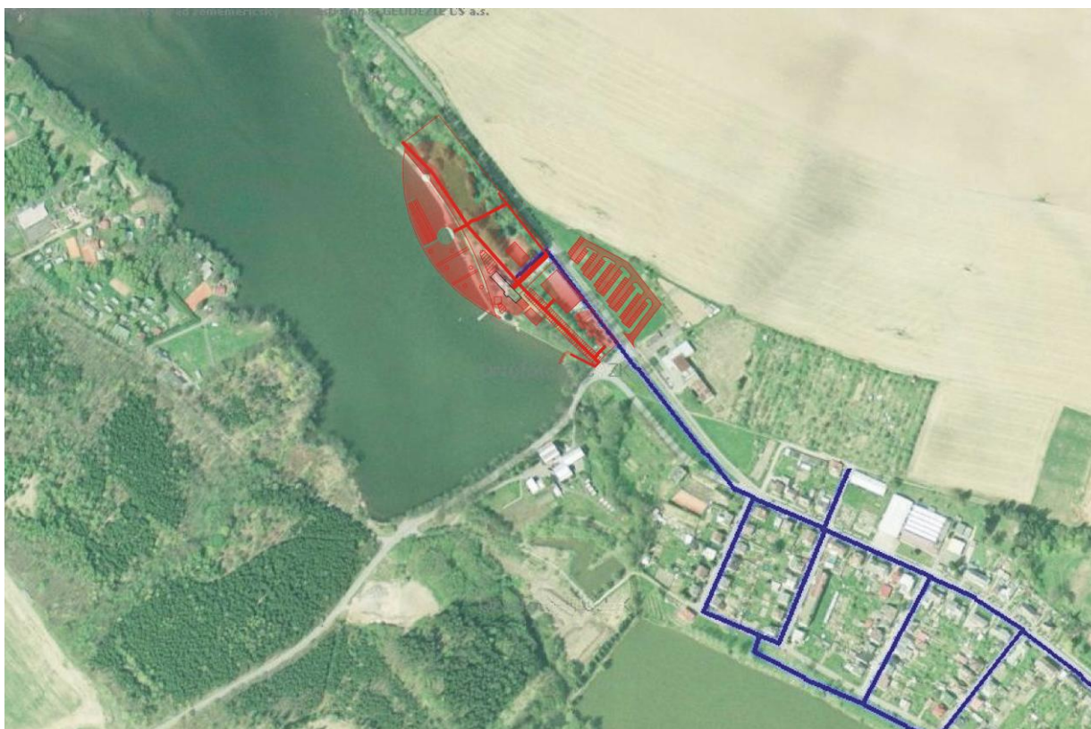
Obr. č. 14: Zákres stavebních objektů do mapy Plánu rozvoje vodovodů a kanalizací Pardubického kraje s vyznačením přívodního vodovodního řadu (bez měř.)
