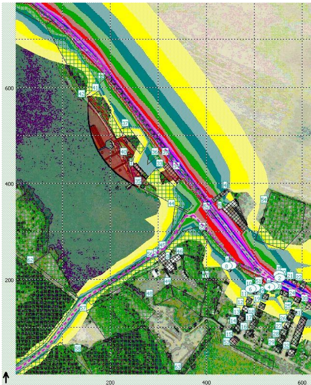
Obr. 51: Posouzení hlukové zátěže – hluk z dopravy na komunikaci III/31514 a místní komunikaci odbočující na hráz rybníka v denní době (stav bez realizace záměru, výška 3 m)
