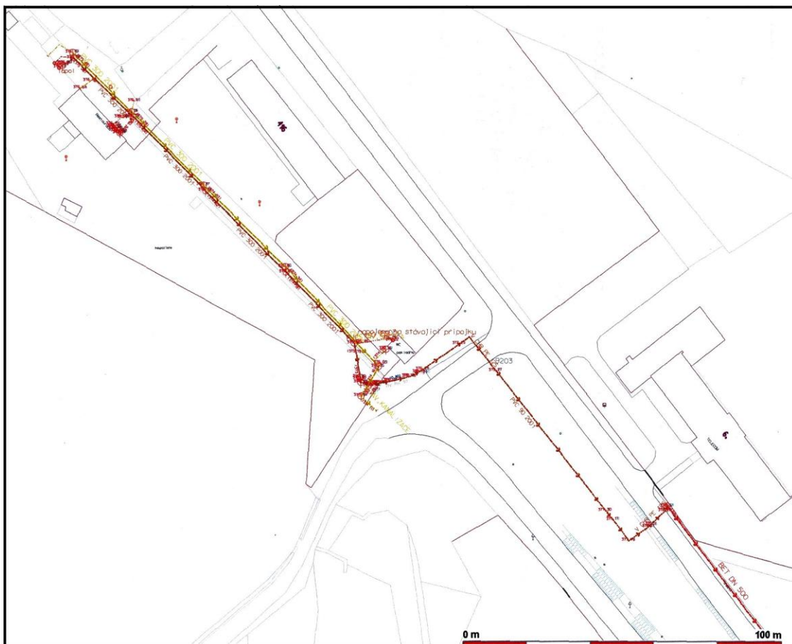
Obr. č. 17: Detail stávající kanalizace v místě realizace záměru
