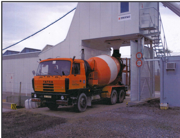
Obr. č. 6: Výsypka betonu do mixu
