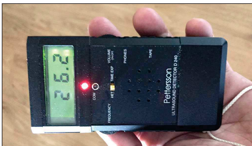
Obr. 8: Ultrazvukový detektor Petterson D 240 používaný při identifikaci netopýřů v posuzované lokalitě.
