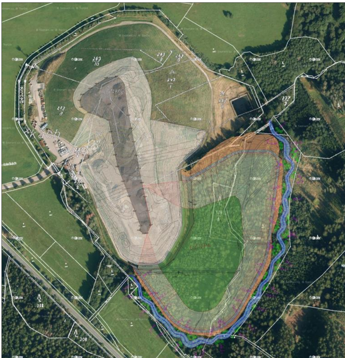
Obrázek č. 7: Navržená přeložka vodního toku, která promítá v návrhu přírodní charakter toku (situace záměru převzata z výkresové dokumentace společnosti Interprojekt. Odpady, 2023) bez měřítka
