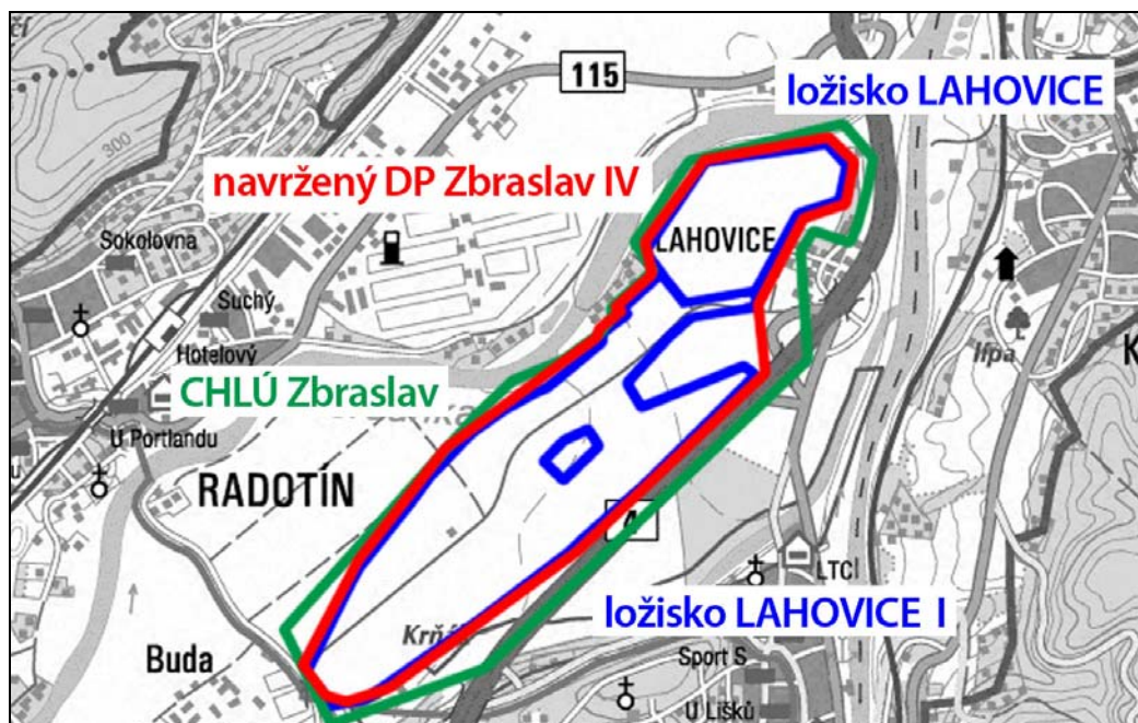
Obrázek č. 2: Znázornění vztahů CHLÚ, výhradních ložisek a dobývacího prostoru
