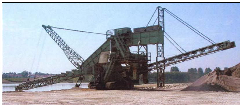
Obrázek č. 6: Ukázka plovoucího korečkového bagru
