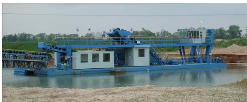
Obrázek č. 6: Ukázka plovoucího korečkového bagru
