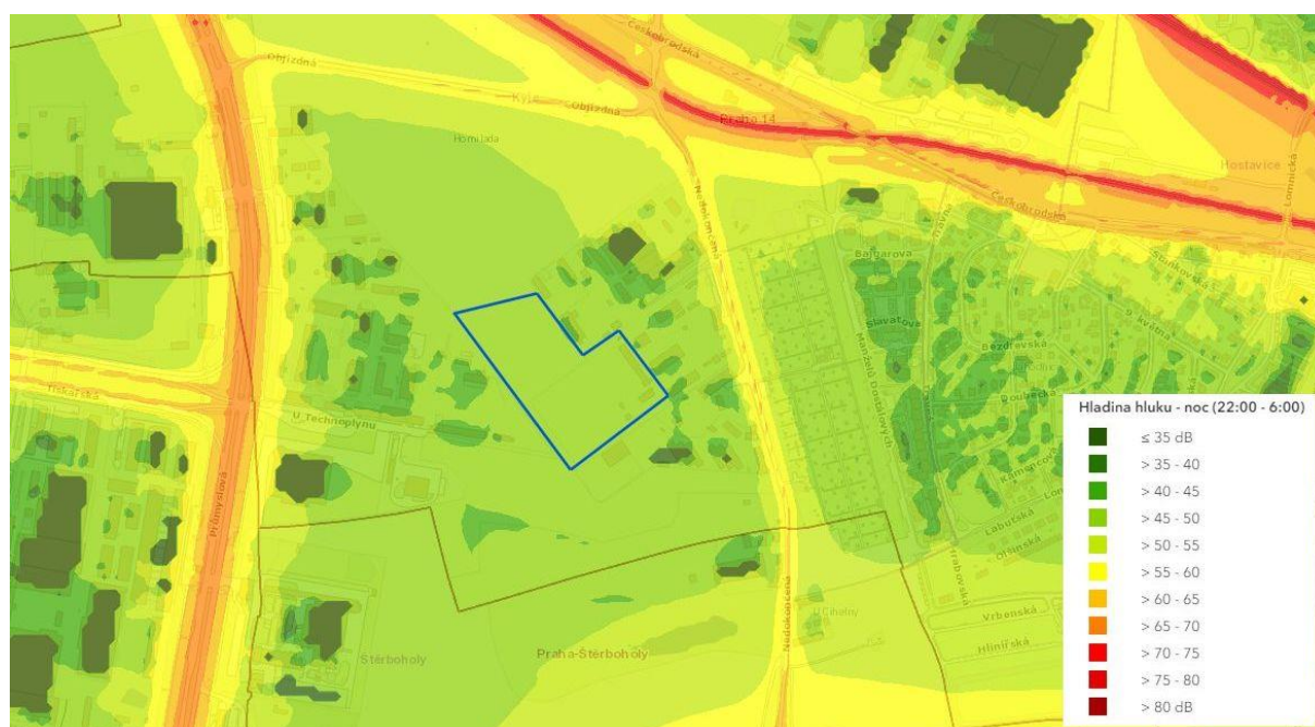
Obr. č. 7 Hluk v noční době (22 – 06 h), výřez z hlukové mapy Prahy
