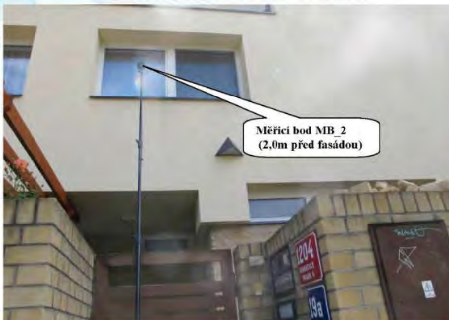
Obrázek 5: Detail místa měření MB_2 před oknem RD č.p. 1204/19a
