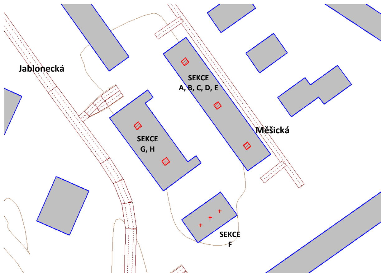
Obr. 11 Situace s předpokládaným rozmístěním stacionárních zdrojů hluku
