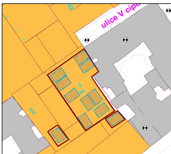
Obr. č. 18 Situace protihlukových clon kolem chladicích jednotek na střeše objektu SO H.01.02
