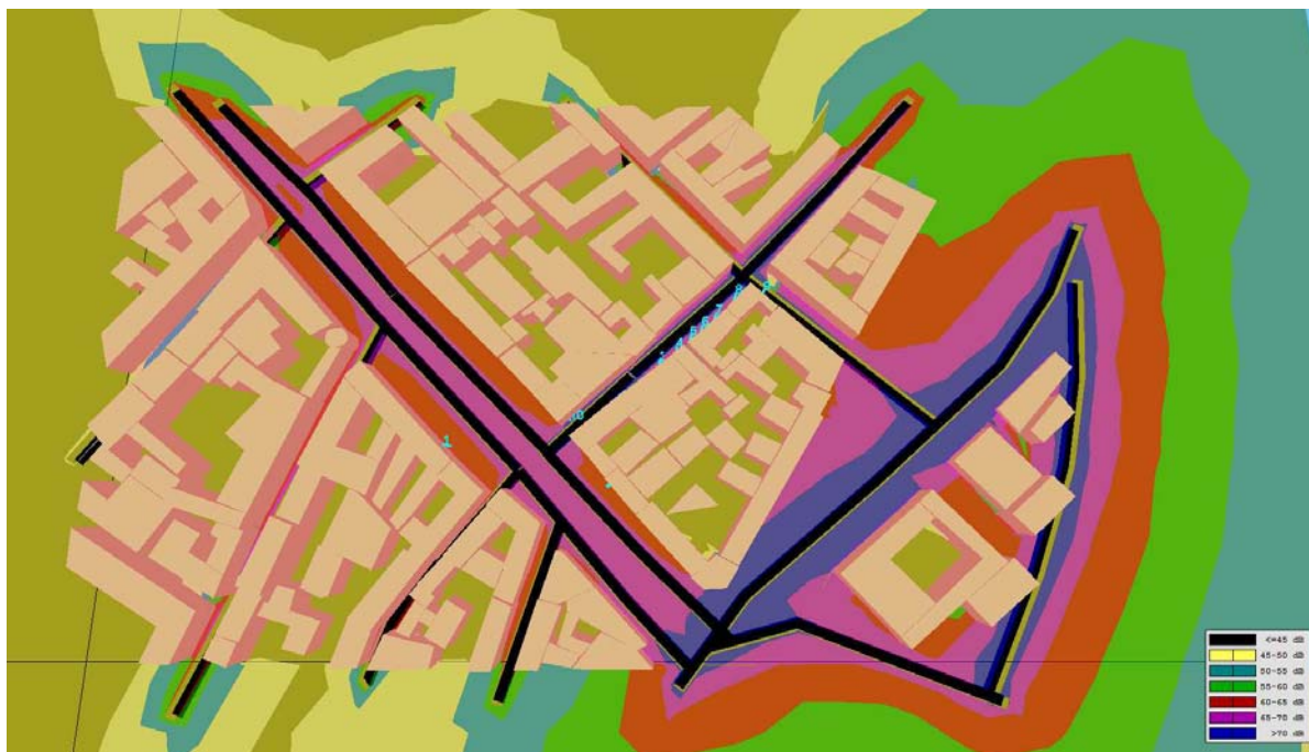
Obr.: Grafické znázornění výpočtového modelu - hluk z pozemních komunikací -budoucí stav 2020 - znázornění pásem izofon 1 (po kalibraci výpočtového modelu naměřenými hodnotami)
