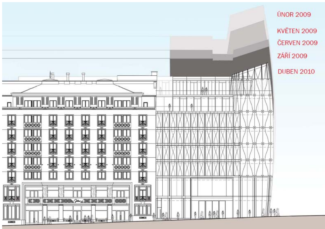
Redukce hmoty objektu v průběhu přípravy projektu
