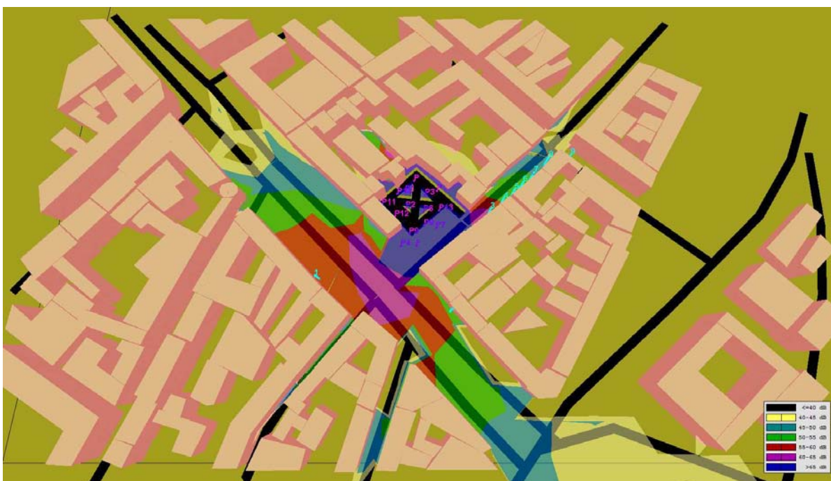
Obr.: Grafické znázornění výpočtového modelu - stavební práce - znázornění pásem izofon 1
