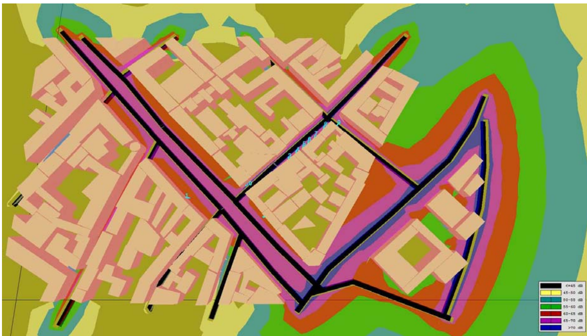
Obr.: Grafické znázornění výpočtového modelu - hluk z pozemních komunikací - budoucí stav 2014 - znázornění pásem izofon 1 (po kalibraci výpočtového modelu naměřenými hodnotami)
