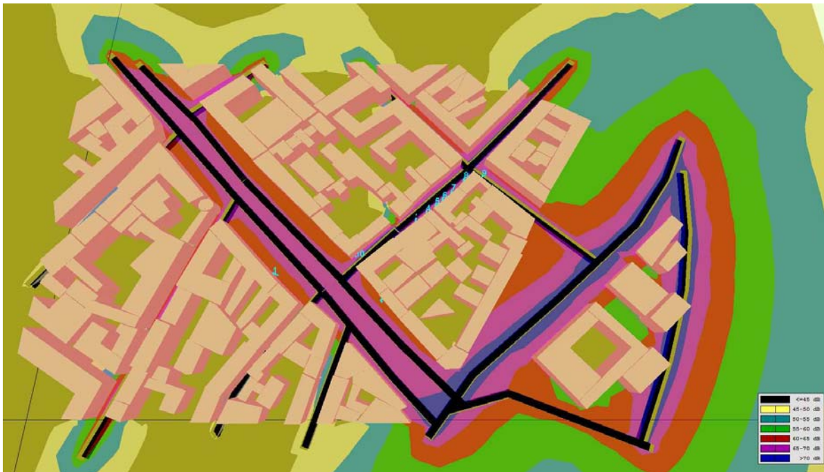
Obr.: Grafické znázornění výpočtového modelu - hluk z pozemních komunikací - budoucí stav 2014 - znázornění pásem izofon 1 (po kalibraci výpočtového modelu naměřenými hodnotami)
