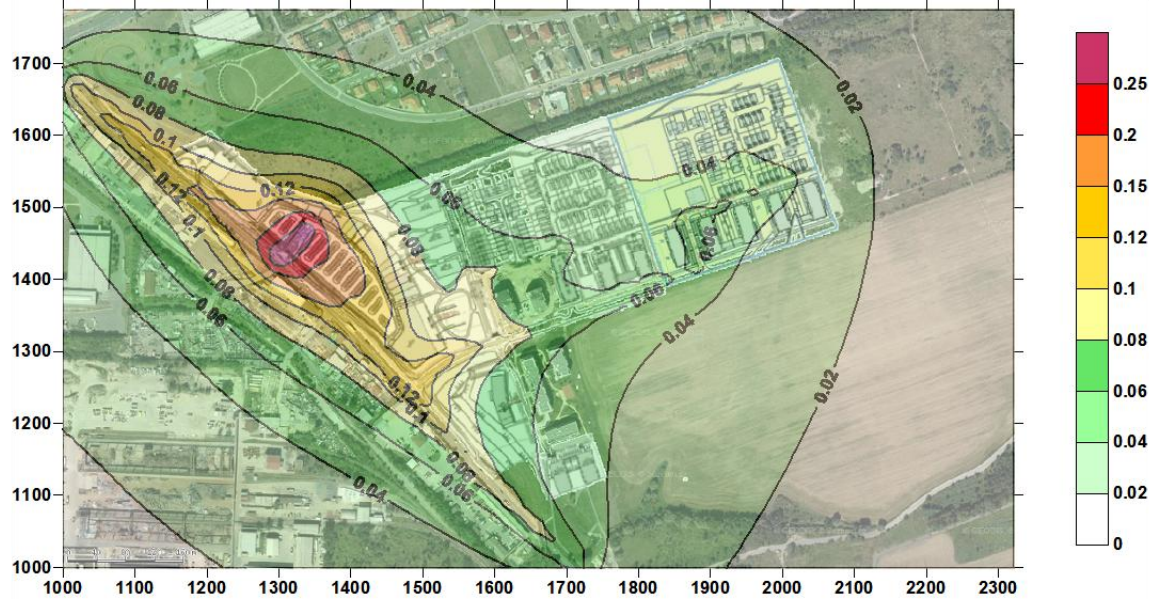
Příspěvek provozu záměrů DUR I až V + DUR DD k průměrným ročním imisím PM 10 (µg/m 3 )
