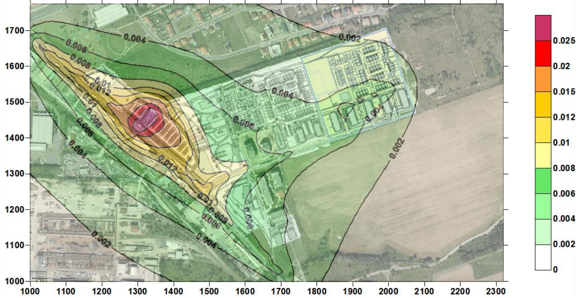
Příspěvek provozu záměrů DUR I až V + DUR DD k průměrným ročním imisím benzenu ( \mu\text{g}/\text{m}^3 )
