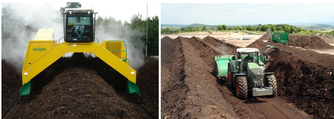
OBRÁZEK 3: PŘEKOPÁVÁNÍ KOMPOSTU SPECIALIZOVANÝMI PŘEKOPÁVAČI
