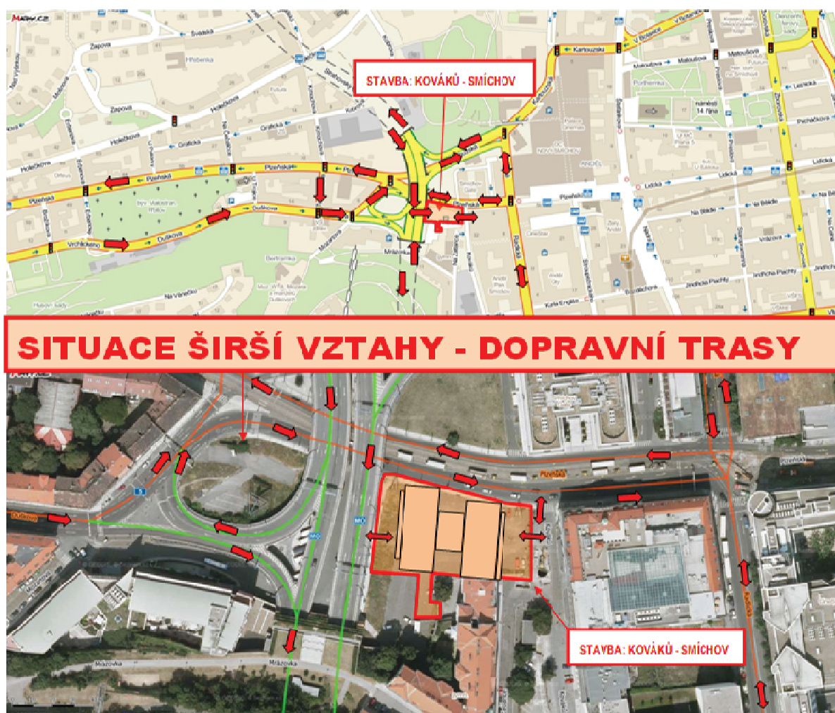
Obr. 11 Dopravní trasy staveništní dopravy (zdroj: podklad [25])
