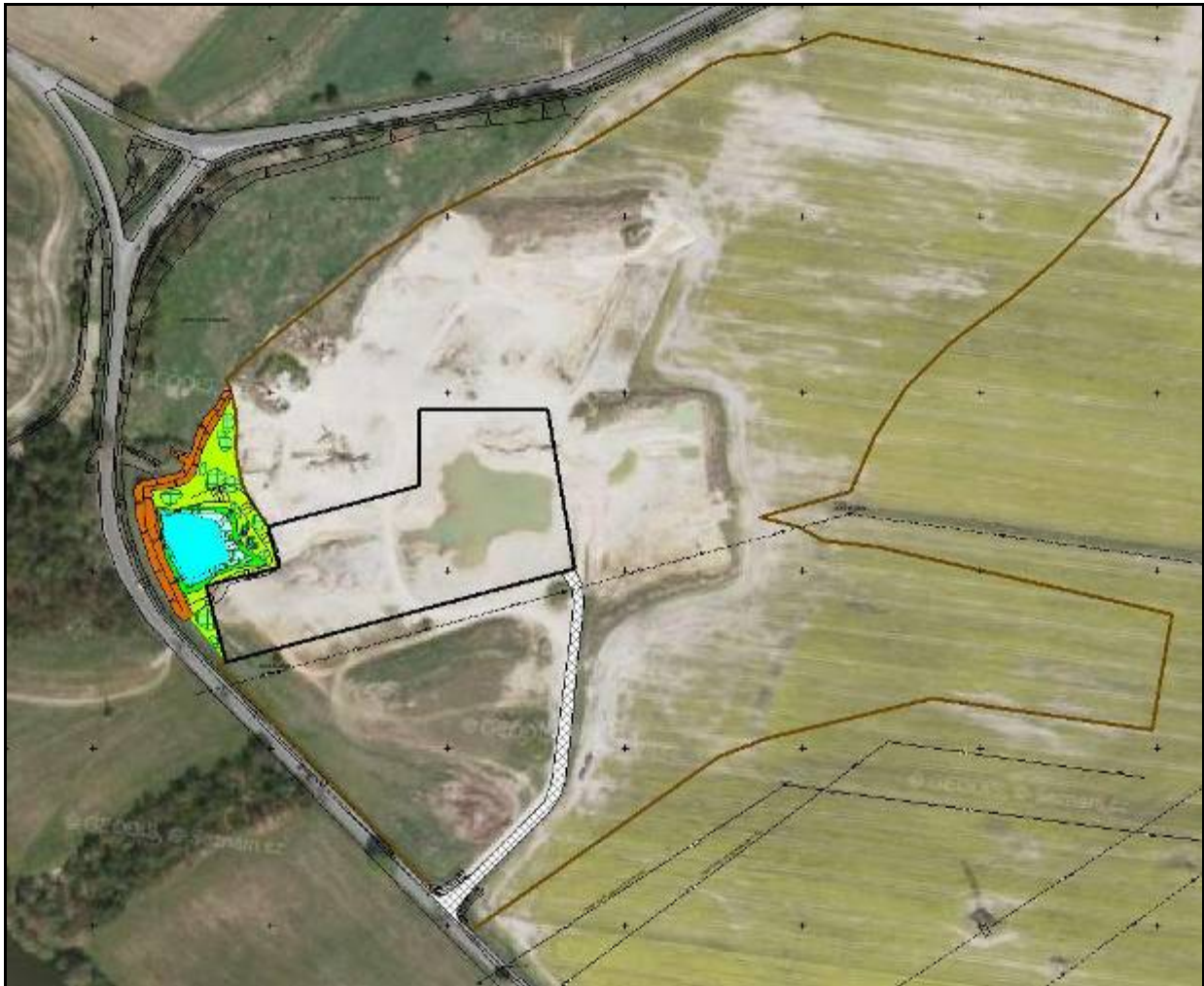
Obr. č. 3. Letecký snímek se zákresem ploch rekultivace – varianta rozšíření pískovny; Zdroj: SPSR
