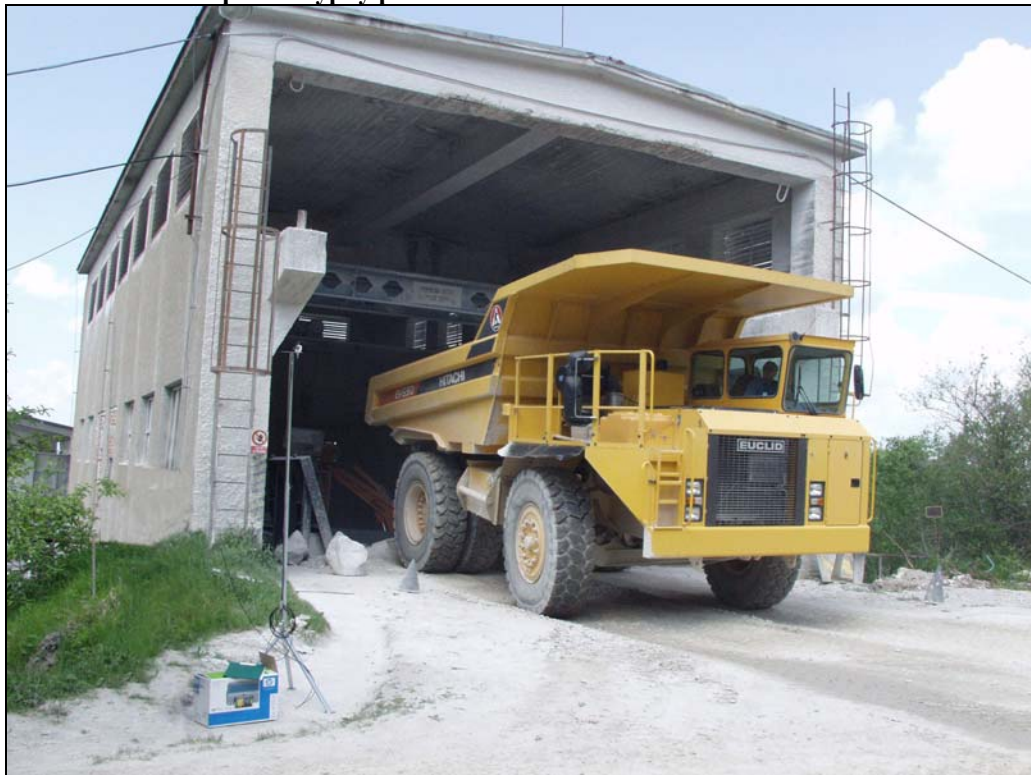
Obrázek č. 5: Dumpr u násypky primárního drtiče
