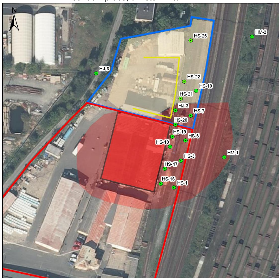
Sanační práce, umístění vrtů
