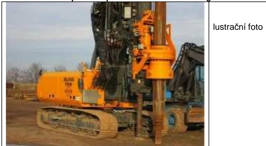
Obr.č.3 Vrtná souprava např. DELMAG Drehbohranlage RH 18
