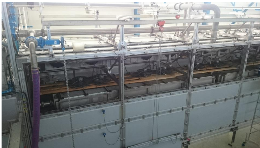
dávkování odvodněného kalu (KKT) do procesu sušení a těleso pásové sušárny STC
