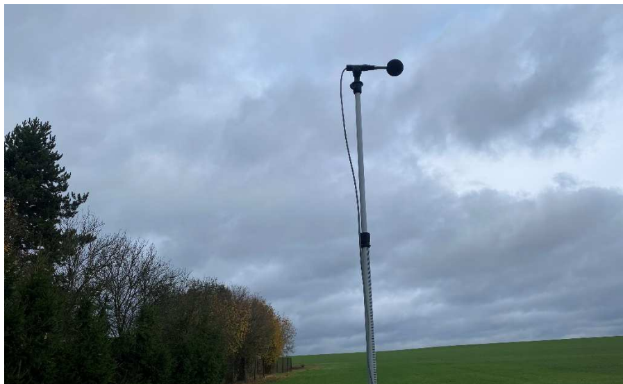
Obr. 16: Měření hluku provozu stacionárních zdrojů hluku obalovny při hranici zahrady rodinného domu ležícího na adrese Valdorf 4, 346 01 Horšovský Týn – Valdorf
