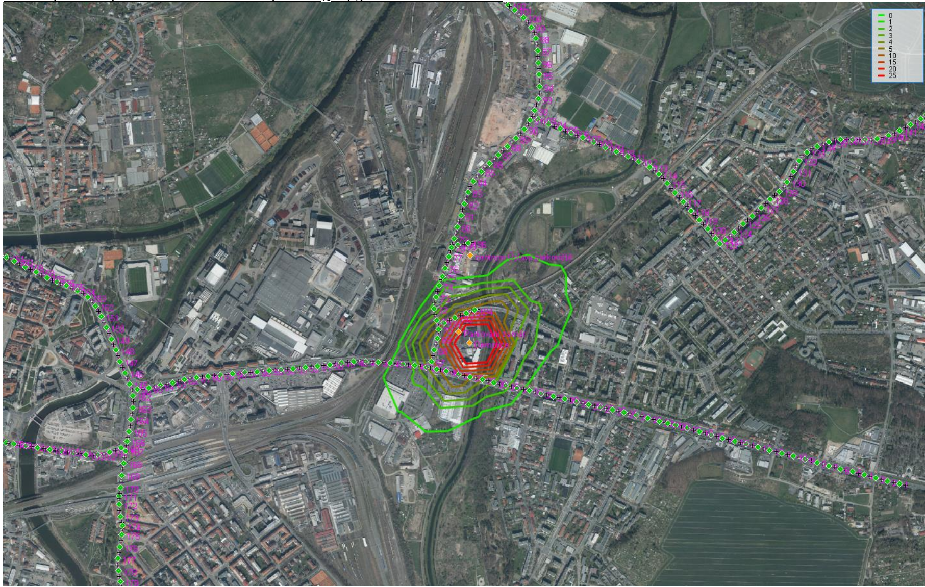
Izolinie průměrných ročních koncentrací pro PM_{10} v \mu\text{g}/\text{m}^3 – období demolic
