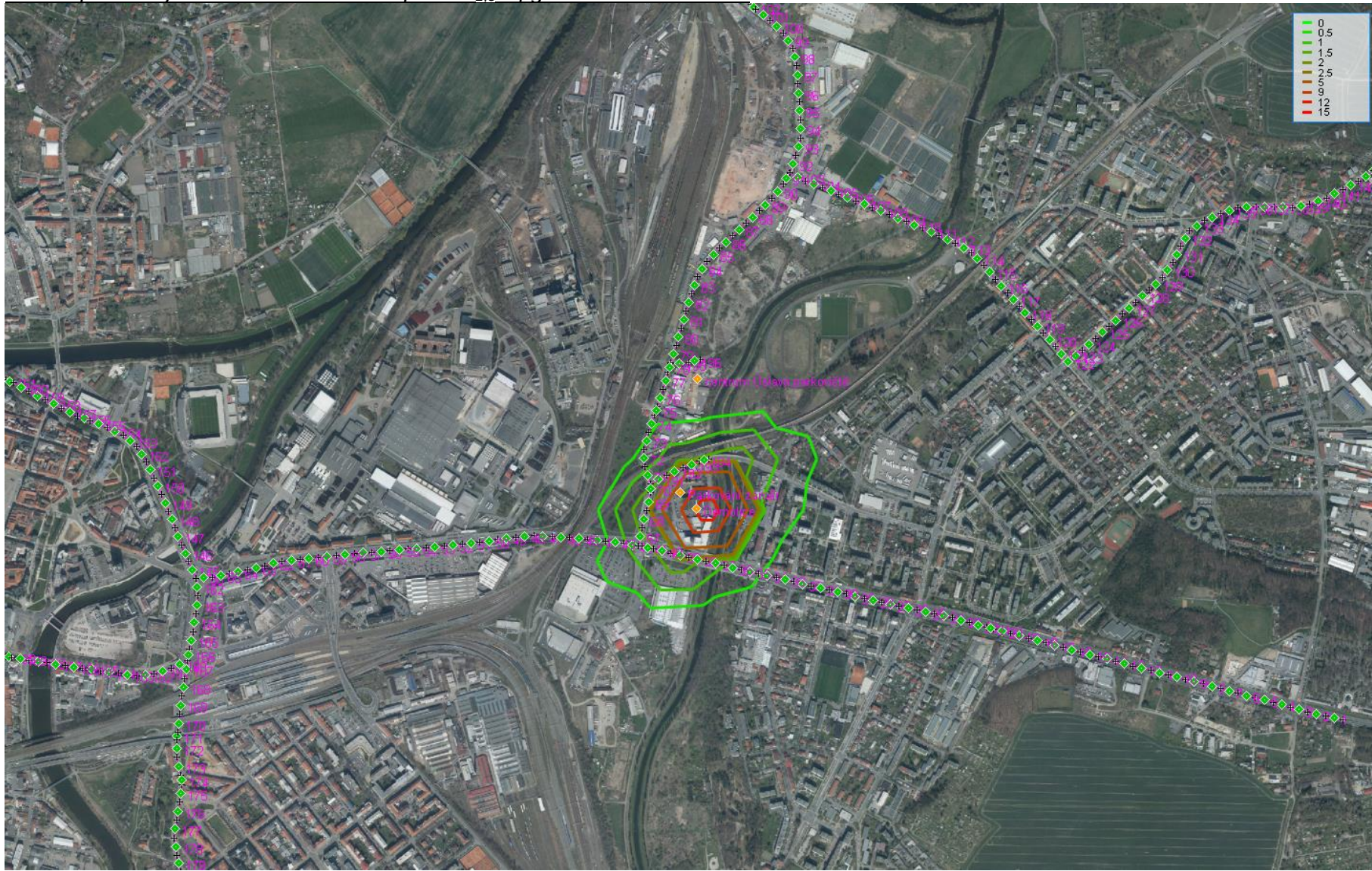
Izolinie průměrných ročních koncentrací pro PM_{2.5} v \mu g/m^3 – období demolic
