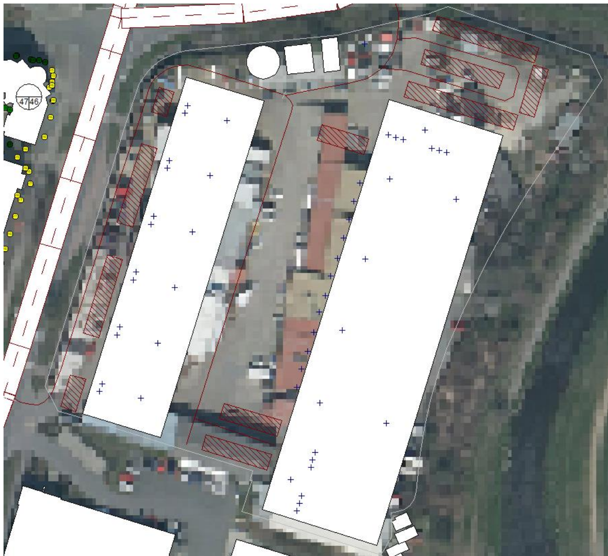
Obr. 5 Zadávané zdroje hlučnosti v programu CadnaA – detail řešený areál
