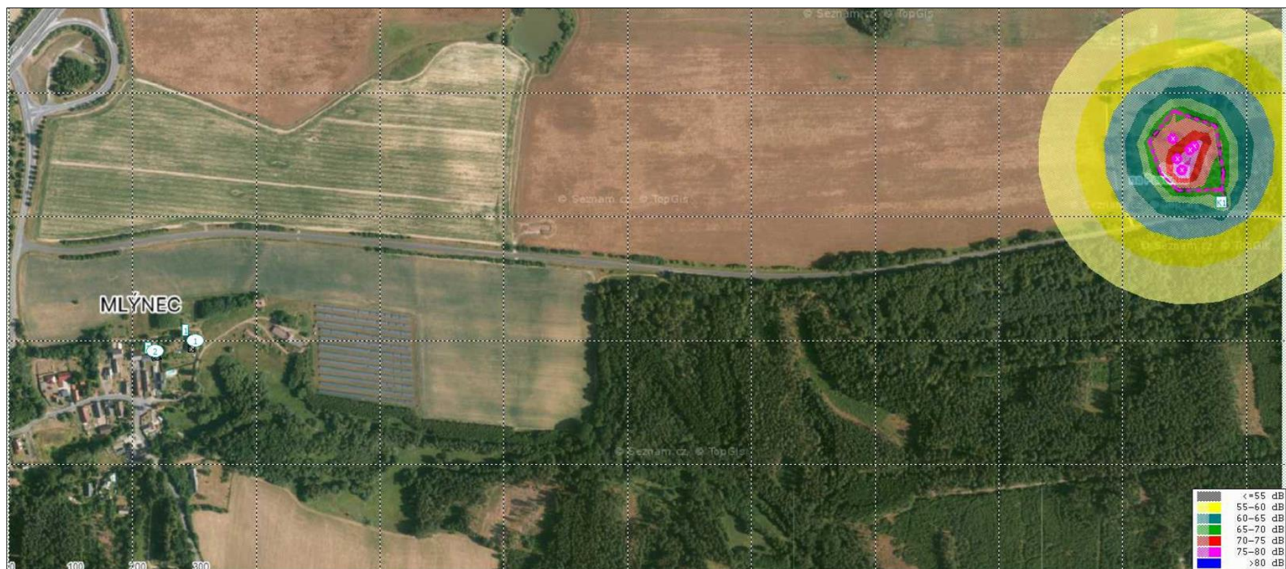
Příloha č. 2: Zobrazení průběhu izofon ve výšce 2 m a 5 m nad zemí – v noční době – stacionární zdroje
