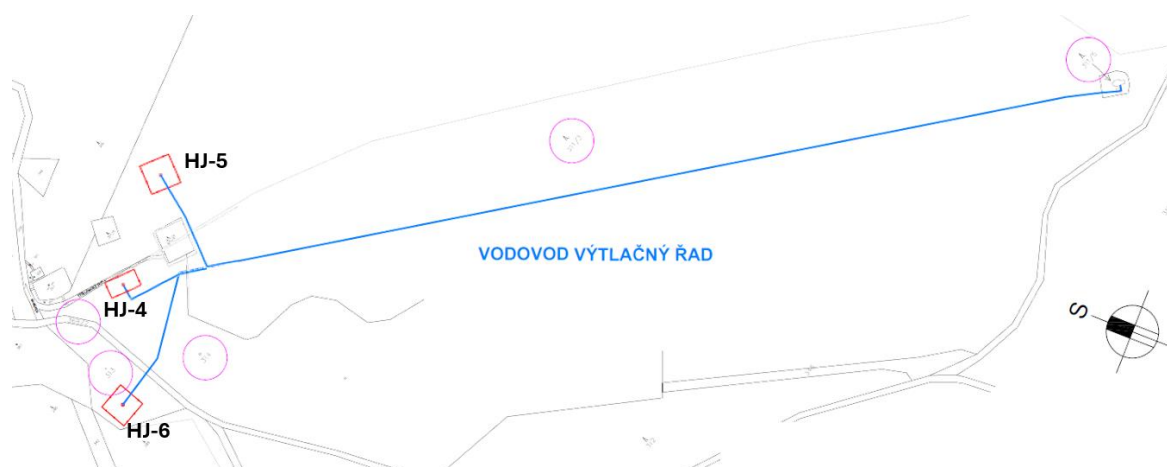
Obrázek č. 1 – Umístění záměru – vrty HJ-4, HJ-5 a HJ-6 a výtlačné řady do spojně šachty
