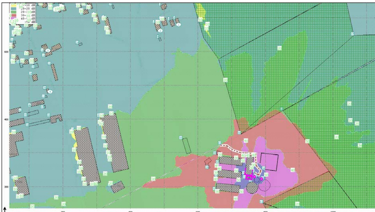
Obr. 6: Grafické znázornění šíření příspěvku hluku od zdrojů hluku spojených s předmětným záměrem pomocí „decibelových pásem“ L_{Aeq,8h} v předmětné lokalitě (výstup z HLUK+) – výpočetní výška 5,0 m, noční doba 22:00 až 6:00 hodin.
