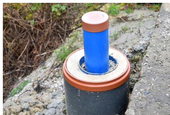
Zhlaví monitorovacího vrtu MV 2
