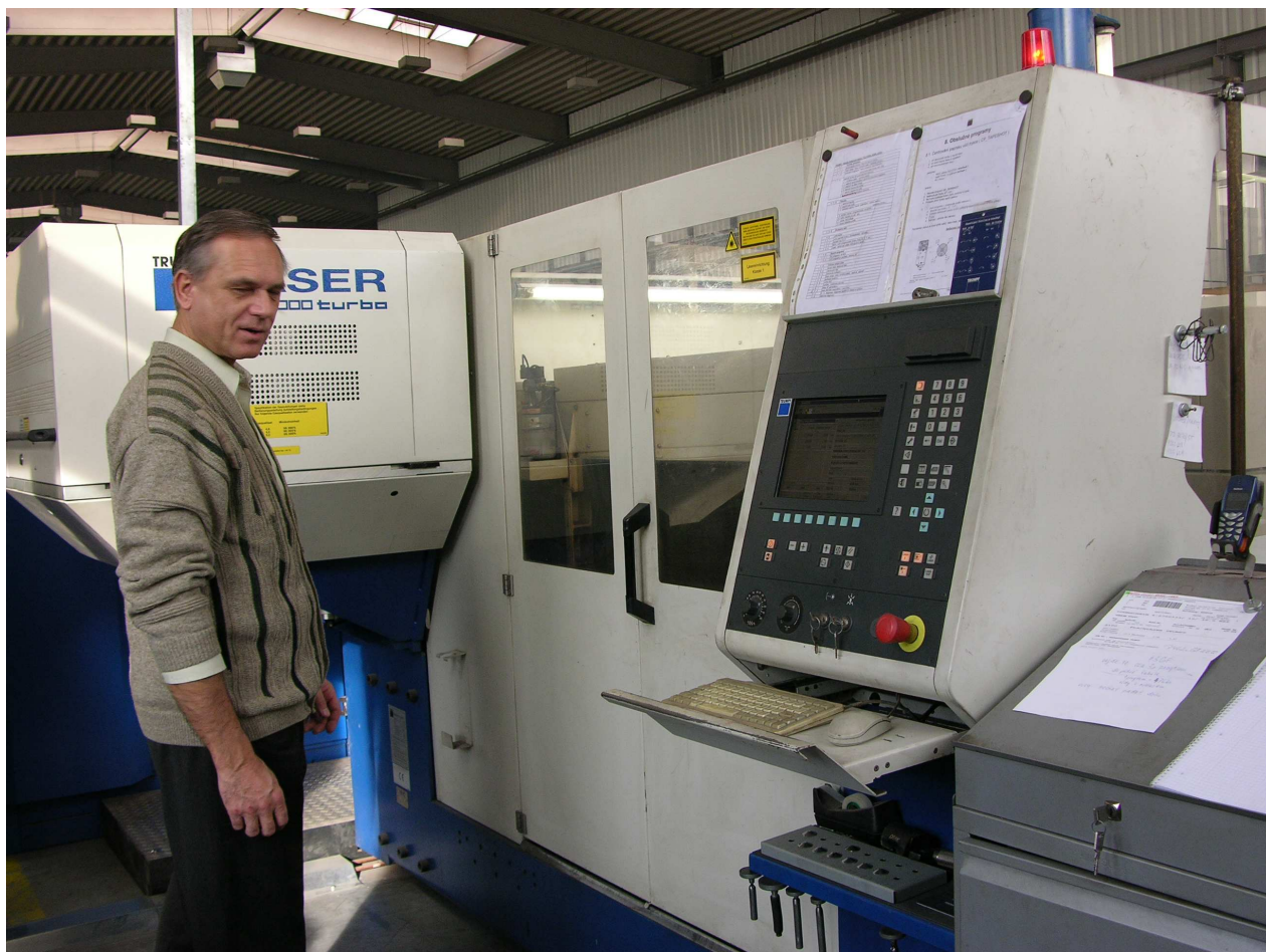
CNC zařízení na laserové vyřezávání plechu, ovládací panel
