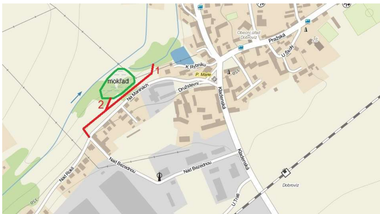
Obr. 8 Návrh vyústění odpadních vod. 1. - lepší řešení do bočního kanálu, 2. - náhradní řešení (s využitím www.mapy.cz )
