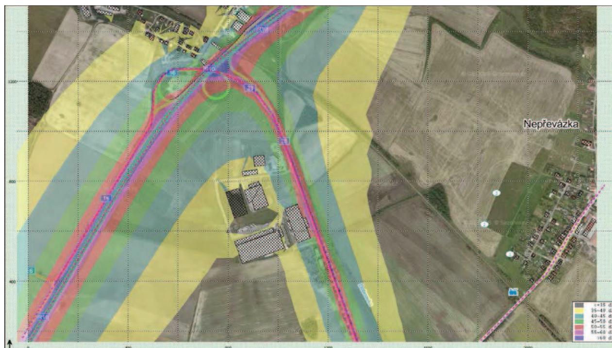
Obr. 7 Grafické znázornění výpočtového modelu - hluk z pozemních komunikací – stávající stav NOC znázornění pásem izofon - výška izofon 5 m nad terémem
