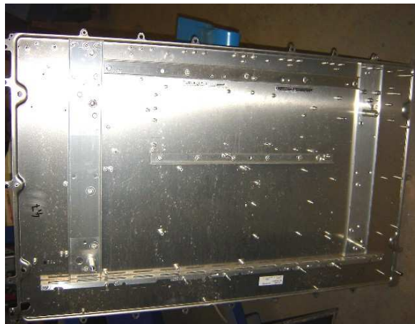
Plazmová obrazovka - Al nosná deska
