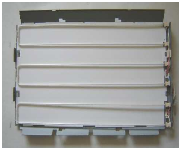
LCD obrazovka - vnitřní část se zářivkami
