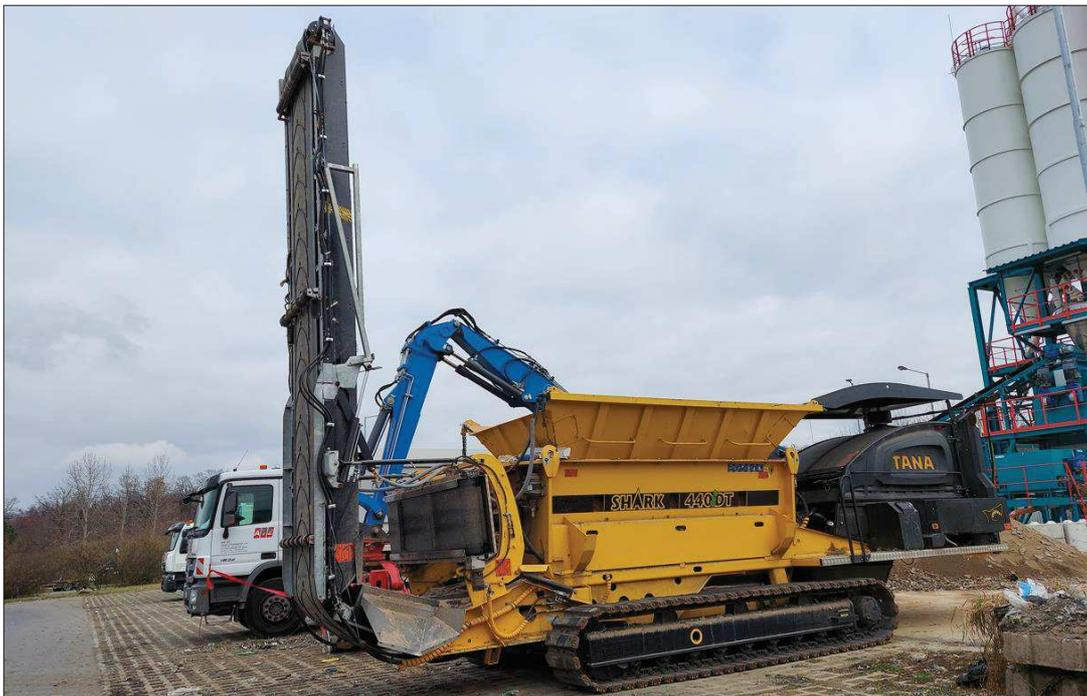
Samotný drtič má vyměnitelné rotorové a oboustranné řezací nože (statorové z vysoce odolného materiálu). Součástí stroje je i magnetický separátor a vynášecí dopravníkový pás. Uvedený drtič je unikátní svou všestranností, umožňuje drcení velkého množství různého typu odpadu.
