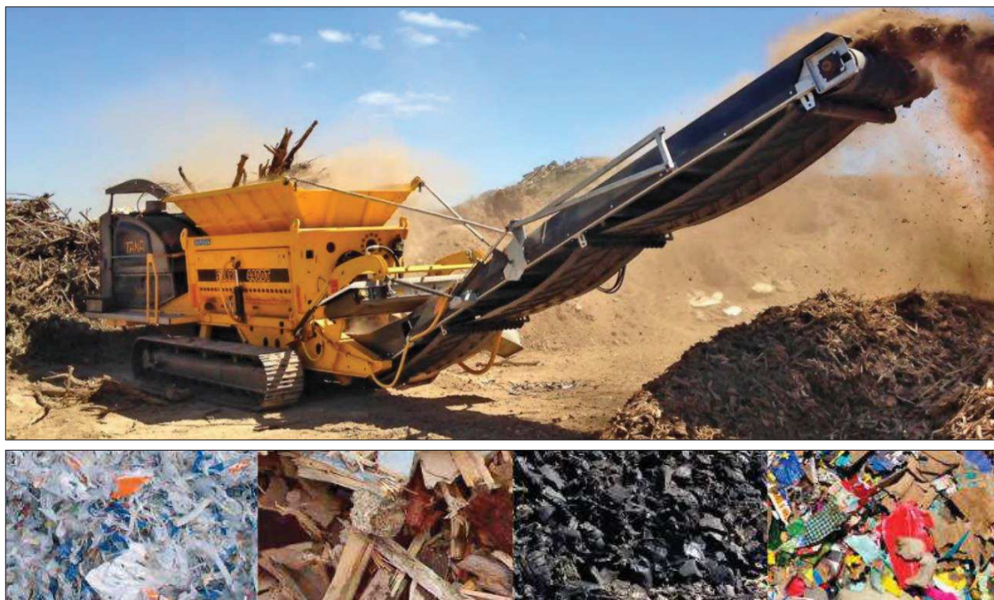
Obrázek č. 10: Drtič odpadů TANA 440DTeco Shark (čerpáno z prospektu výrobce)
