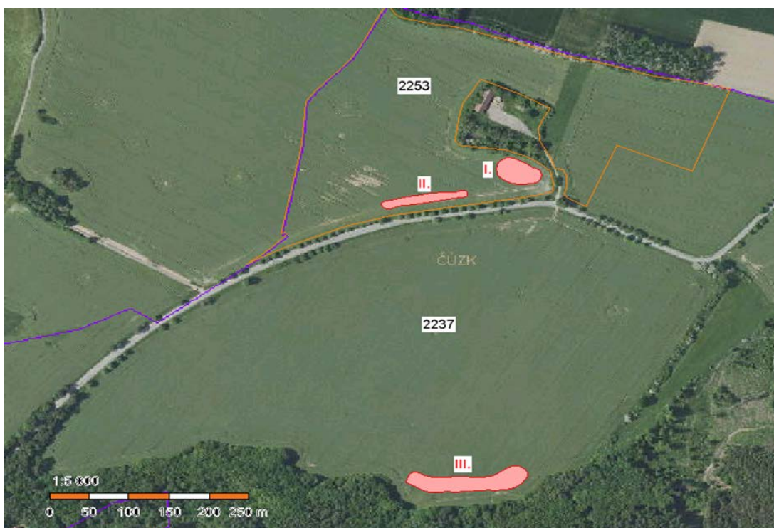
Obrázek č. 6 Dočasné deponie zeminy z HTÚ
